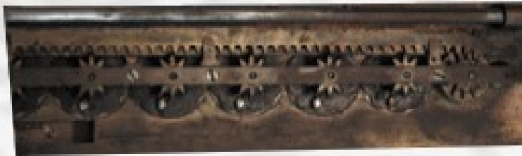
détails de la machine de Thomas, dessous la platine mobile laissant voir le système de remise à zéro
