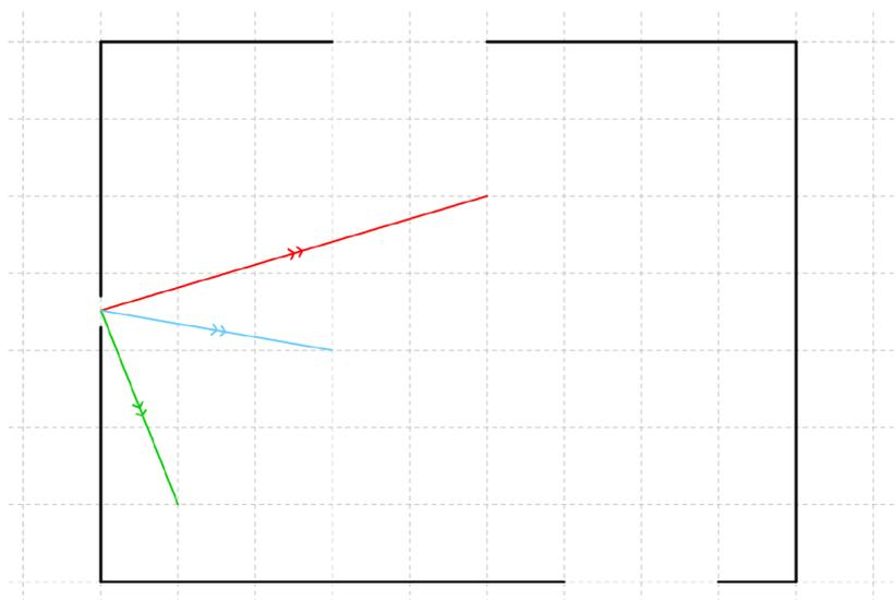
Attention ! les parties non colorées du bord de la pièce sont des fenêtres qui ne réfléchissent pas les rayons lumineux... On considère ici que les rayons sont trop faibles pour être encore visibles après 3 réflexions.
